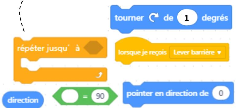
4/ De la même façon, cliquer sur l'objet barrière gauche et réaliser les 2 programmes
