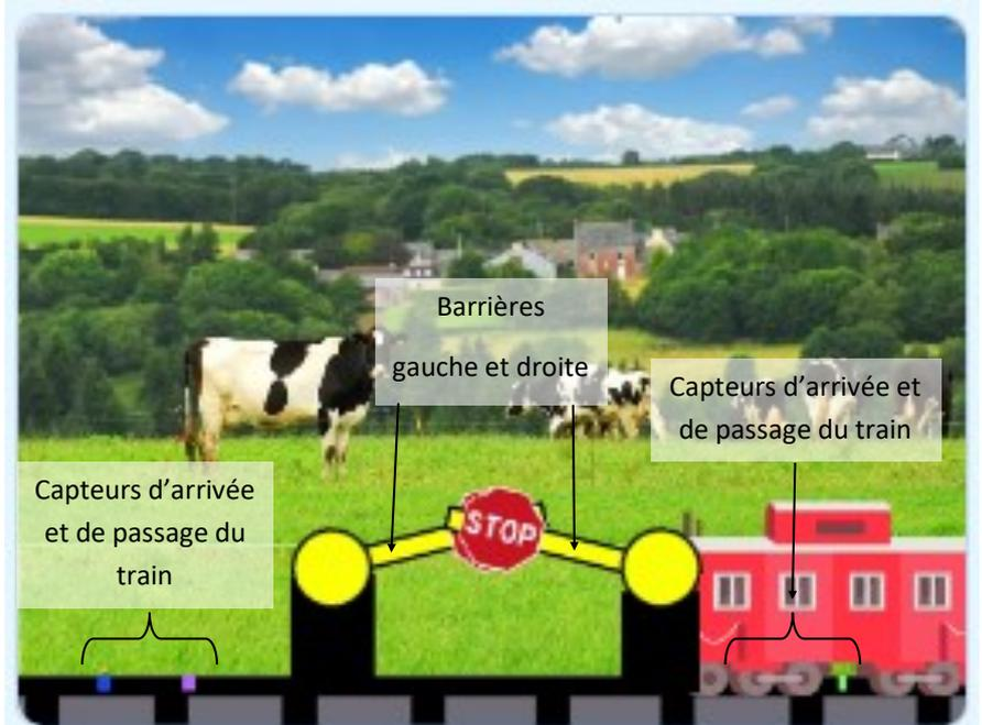
**1/ L'arrière plan** est constitué des rails, des 2 poteaux et des 4 capteurs permettant de détecter l'arrivée ou le passage du train
