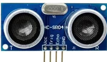
Ce composant s'appelle un capteur à ultrason, il permet de détecter un obstacle devant lui et d'en calculer la distance : un émetteur envoie un signal ultrason devant lui et un récepteur pourra capter l'écho du signal s'il heurte un obstacle et en calculer la distance.
